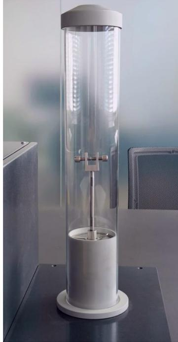
图 5-4-1 试验燃烧筒及混气室
